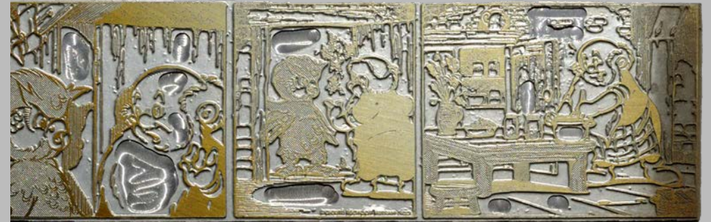
Olle Kapoen. Aluminium clichés voor het drukken van de strips van Olle Kapoen in de dagbladen, circa 1950.
